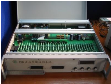
Fig1(a). 128道全心房心外膜标测采集系统
